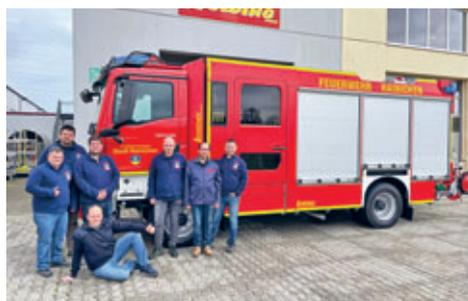
ein Allradfahrgestell und wurde in den letzten Monaten von der Firma Josef Lentner GmbH aus Hohenlinden nach den Vorstellungen der Hainichener Kameraden aufgebaut. Das Fahrzeug ist mit LED-Scheinwerfern, einer Rotzler Seilwinde, einem Löschwassertank mit 2.400 Litern, einer Verkehrs- und einer Schlauchhaspel ausgestattet.
